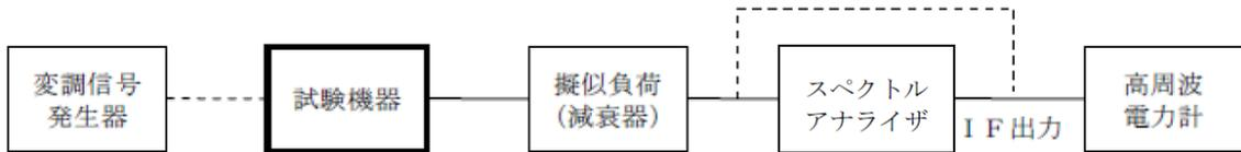
注：擬似負荷(減衰器)の出力端に直接高周波電力計を接続するのは、直交周波数分割多重方式又は直接拡散を使用するスペクトル拡散方式以外の方式を用いるものの総電力を測定する場合である。
